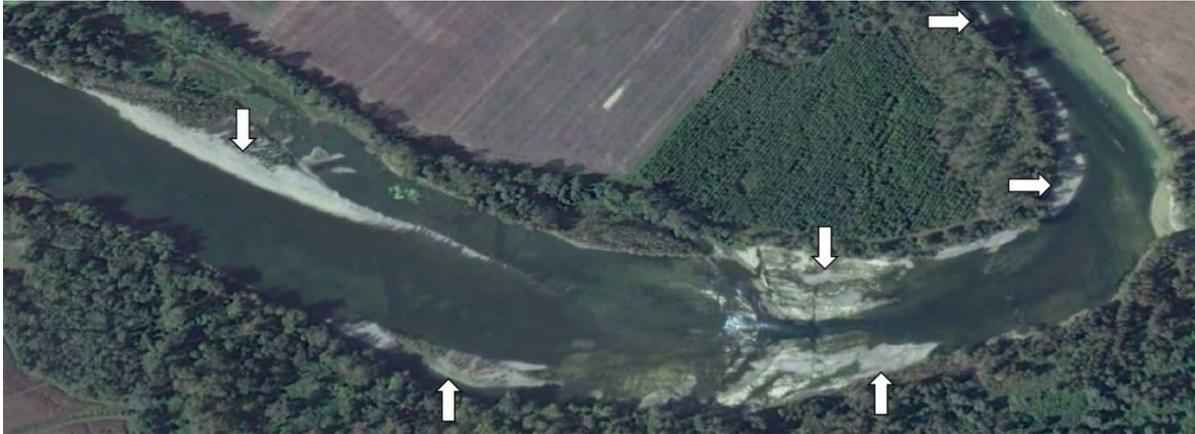
**Figure 3.78** : Exemple du site de Grenade sur lequel des atterrissements (flèches) sont observés le long du tronçon (Google Earth).
