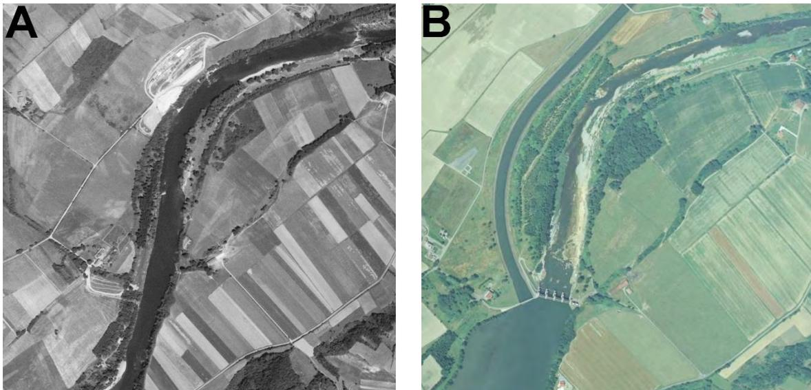
**Figure 2.28** : Evolution du chenal sous l'effet de la mise en place d'un barrage mobile dans le secteur de Cazères sur la Garonne amont entre (A) 1962 et (B) 1993 (IGN). Les deux photographies présentent des débits relativement proches qui sont respectivement de  $128 \text{ m}^3 \cdot \text{s}^{-1}$  et  $103 \text{ m}^3 \cdot \text{s}^{-1}$ .
