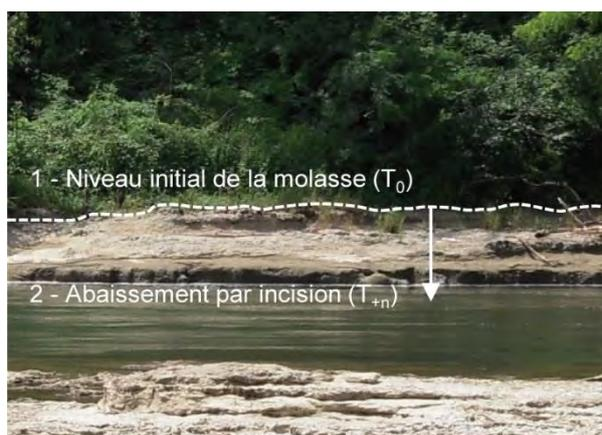
Figure 3.57 : Photo représentant le niveau initial de la molasse (pointillés blancs) une fois mise à nue par décapage de la charge alluviale. L'altitude mesurée sert de niveau de référence ( $T_0$ ) pour l'estimation de l'incision.
