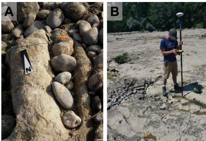
**Figure 1.39 :** (A) Forme en sillon à l'intersection d'un transect symbolisé par le fil avec orientation de cette dernière. (B) Lever de la position d'une forme par DGPS.
