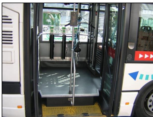
Figure 26 : Accroches vélo à l'intérieur des bus du STAC (Chambéry) (source : alain.caraco.free.fr , 2005)
