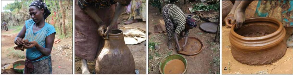
Figure 12 : Pression continue. 1 : mise en forme du bord d'un petit couvercle ; 2 : mise en forme du col et de la lèvre d'une Otto ; 3 : mise en forme du bord d'un Bashe ; 4 : mise en forme du bord d'un Kere et réalisation de décors.
