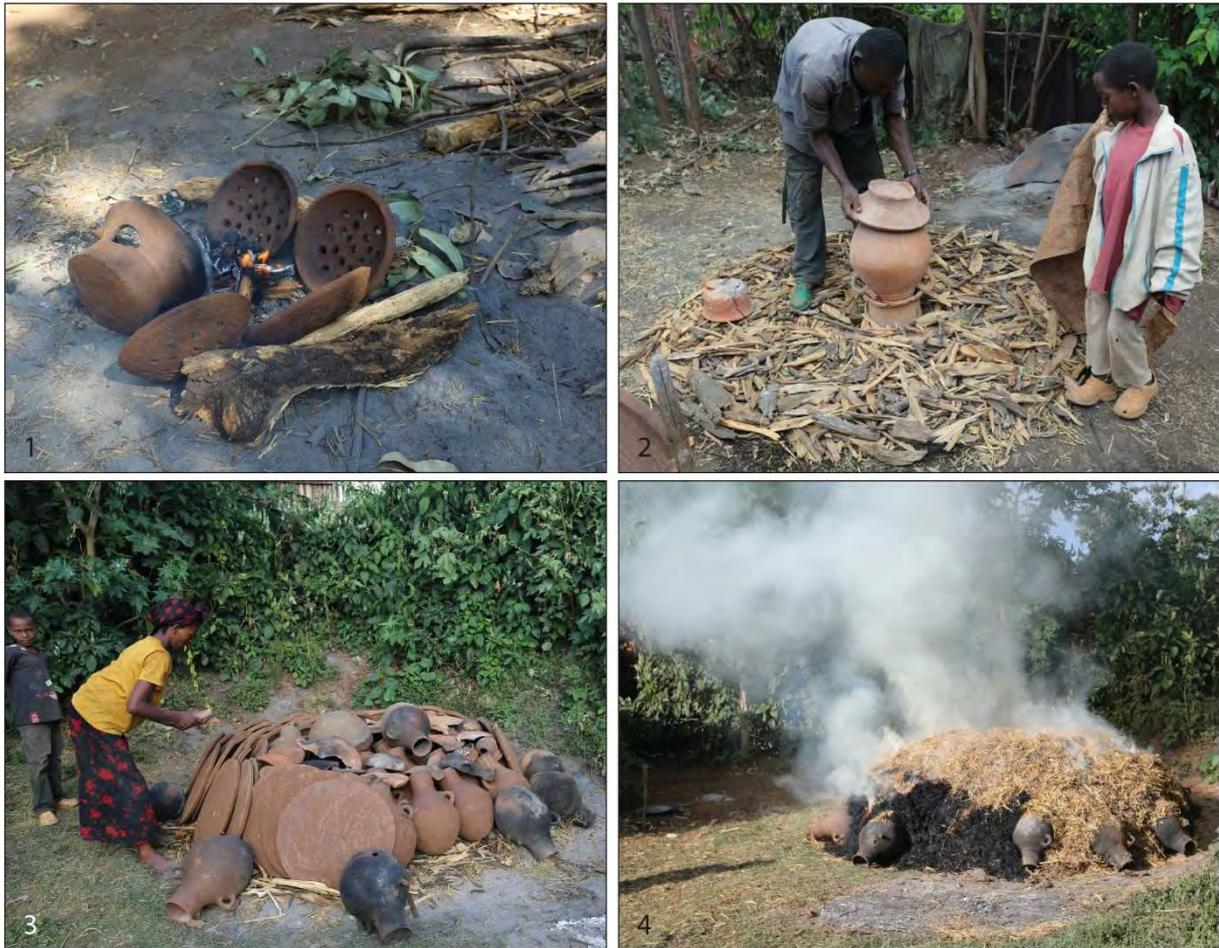
Figure 17 : opérations relatives à la cuisson des vases. 1 : dispositif de pré-cuisson ; 2 : installation du support central ; 3 : disposition des vases à cuire et des tessons ou vases de calage ; 4 : aspect final de la structure en meule.
