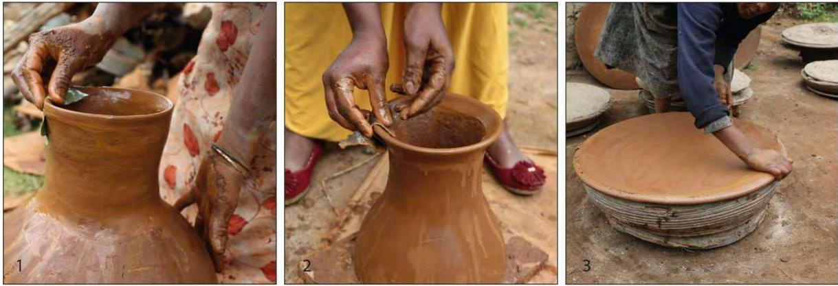
Figure 24 : pression continue. 1 : à l'aide d'une feuille d'arbre humide ; 2 : à l'aide d'un tissu humide ; 3 : à la main mouillée.
