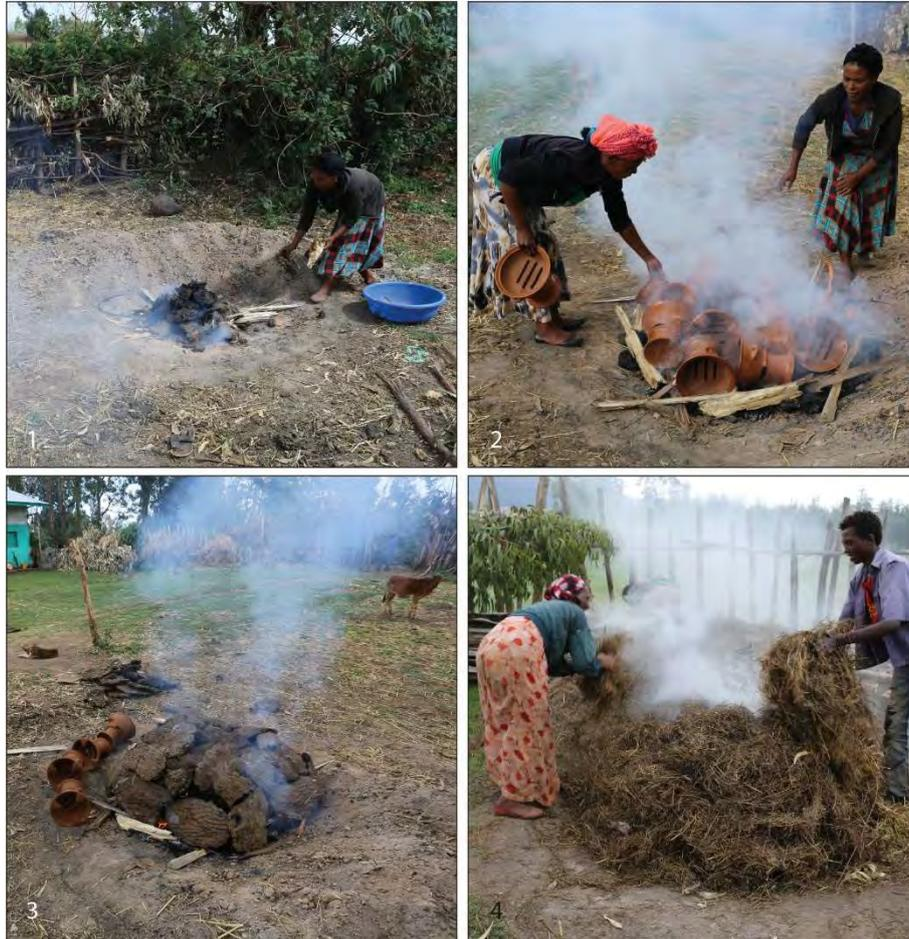
*Figure 28 : opérations relatives à la cuisson des vases des chaînes opératoires CO1 à CO4. 1 : départ du feu au centre du petit creusement ; 2 : installation des vases ; 3 : formation d'une meule avec des bouses de vaches séchées et disposition des vases en cours de séchage près du foyer ; 4 : ajout de paille en meule.*
