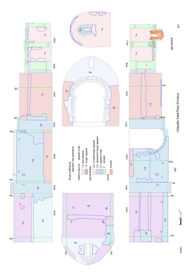
Fig. 94 : Répartition des parements intérieurs
