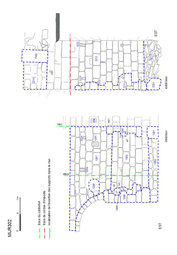
Fig. 34 : Schéma du mur M302, nef sud centre
