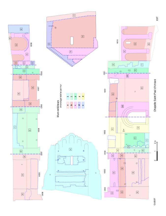
Fig. 99: Murs extérieurs, chronologie relative par mur
