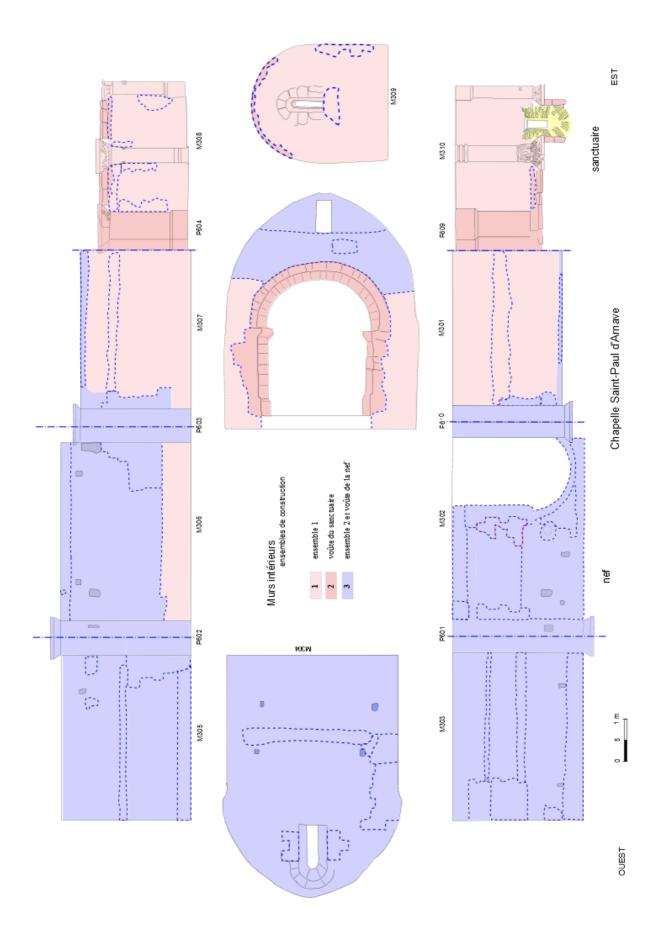
Fig. 100 : Murs intérieurs, phases de construction
