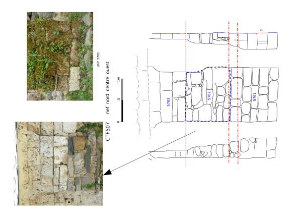
Fig. 74 : Schéma du contrefort C507
