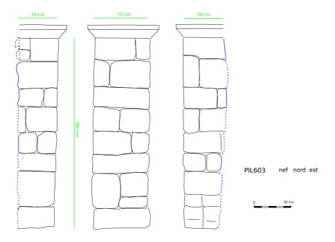
Fig. 59 : Schéma du pilier P603, nef nord est
