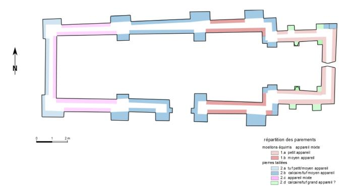
Fig. 96 : Plan de la répartition des parements
