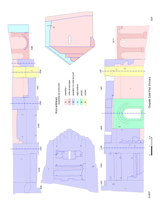
Fig. 101: Murs extérieurs, phases de construction
