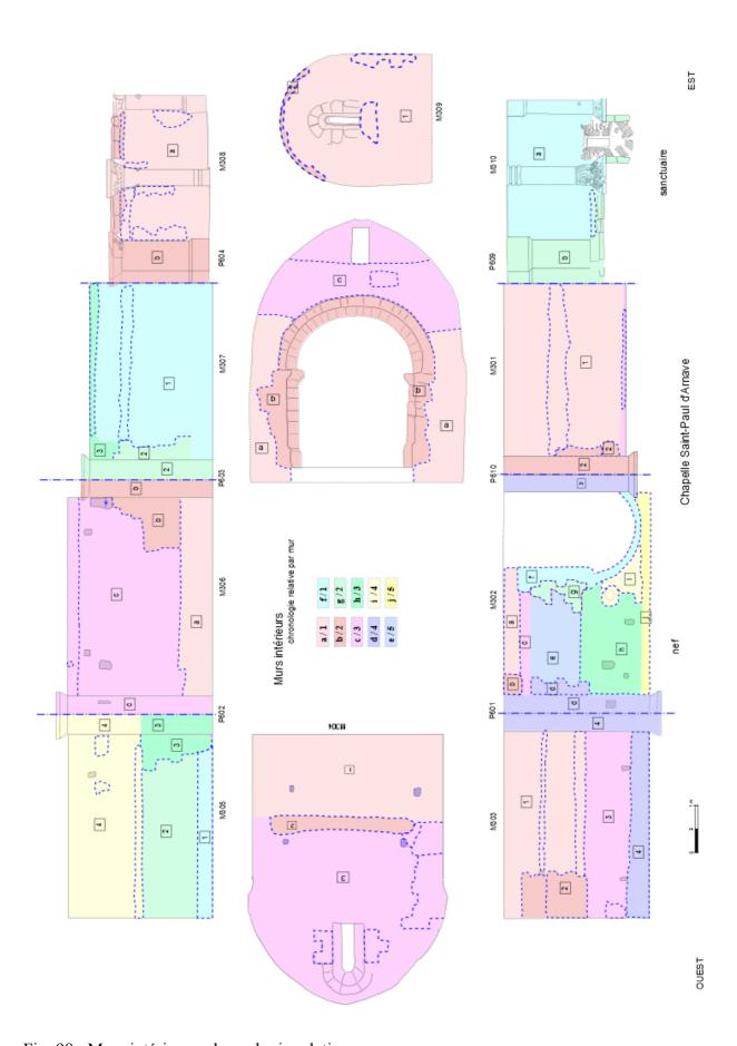
Fig. 98: Murs intérieurs, chronologie relative par mur
