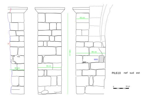
Fig. 60 : Schéma du pilier P610, nef sud est
