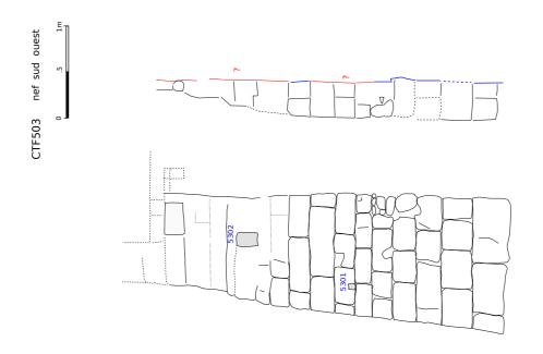
Fig. 69 : Schéma du contrefort C503
