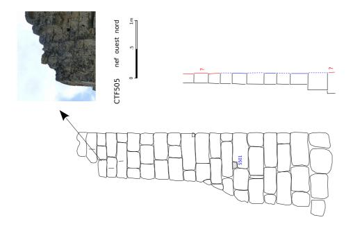
Fig. 72 : Schéma du contrefort C505
