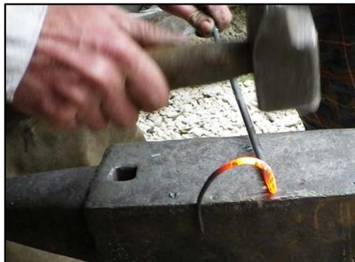
**Fig. 76** : Pliage de la tige en angle droit à environ 20 cm de la pointe effilée.
