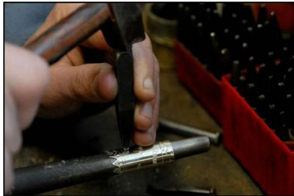
**Fig. 34** : Réalisation d'un décor poinçonné pour la confection d'un makhila (bâton de marche traditionnel basque). Photographie : Atelier Ainciart Bergara
