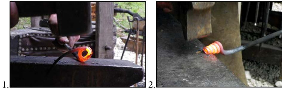
**Fig. 77 :** 1. Enroulement de la partie effilée pour obtenir une série d'anneaux.
