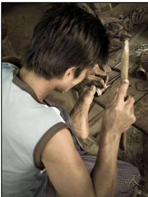
**Fig. 33** : Orfèvre birman tenant un objet à l'aide de son pied afin de réaliser un décor ciselé à l'aide d'un marteau en fer avec un manche en bois et d'un ciselé en acier. Photographie : Christine Keller.
