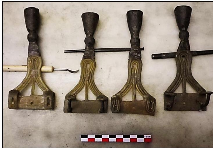
**Fig. 60 :** Étape 6 : Fixation de l'entonnoir + masselotte. De gauche à droite : agrafe expérimentale n°1, n°2, n°3, n°4
