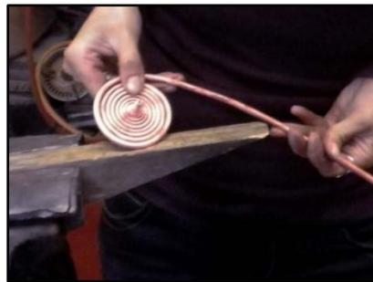
**Fig. 90** : Enroulement de la partie plane. (Photographie : B. Clarke)
