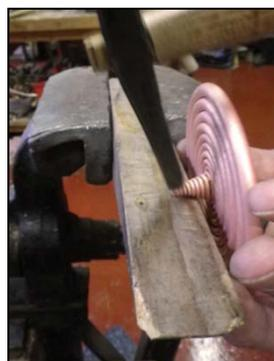
**Fig. 92** : Resserrement de la pointe du cône spiralé par martelage.
