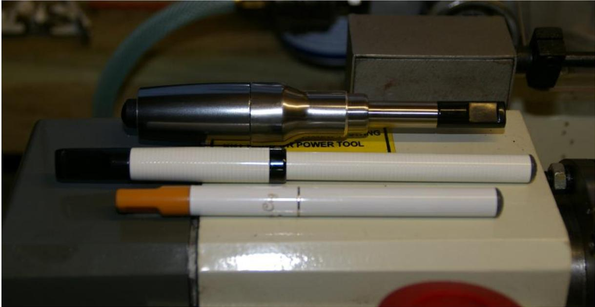
Fig.4 : Photographie d'un *screwdriver* (en arrière plan) et de deux *cigalike*
