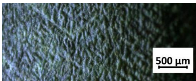
Figure 23 : La microstructure dendritique toujours visible à la surface du bracelet n°48.
