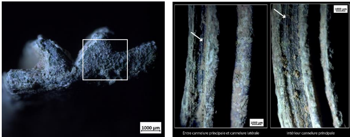
Figure 10 : A gauche la microstructure dendritique du bracelet n°412 visible sur une cassure (encadré). A droite , les boursoufflures rectilignes sur les cannelures du même objet. Les deux images montrent les angles aigus formés par les cannelures, formant des contre-dépouilles.
