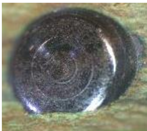
Figure 5 : la zone d'abrasion sur l'anneau n°1.
