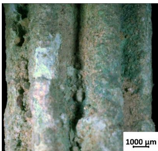
Figure 11 : Les cannelures du bracelet n°368. Elles ne présentent pas de contre-dépouille.
