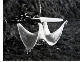
(Fig.22) Modèle suspendu par Heinz Isler
