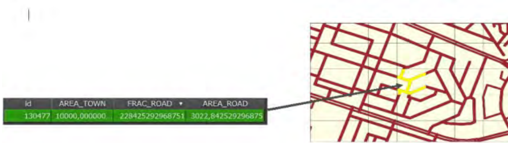
Figure 5: Exemple de calcul de la fraction de route dans une maille urbaine
