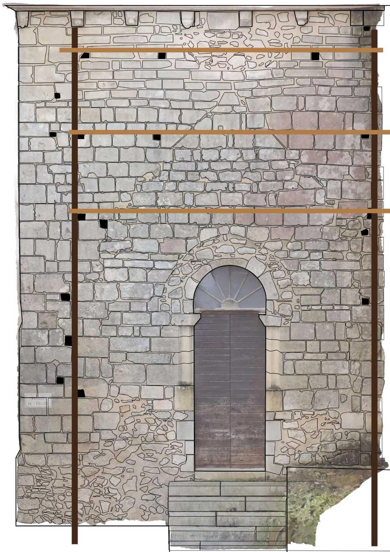
Figure 40 : Restitution des échafaudages sur la façade romane occidentale
