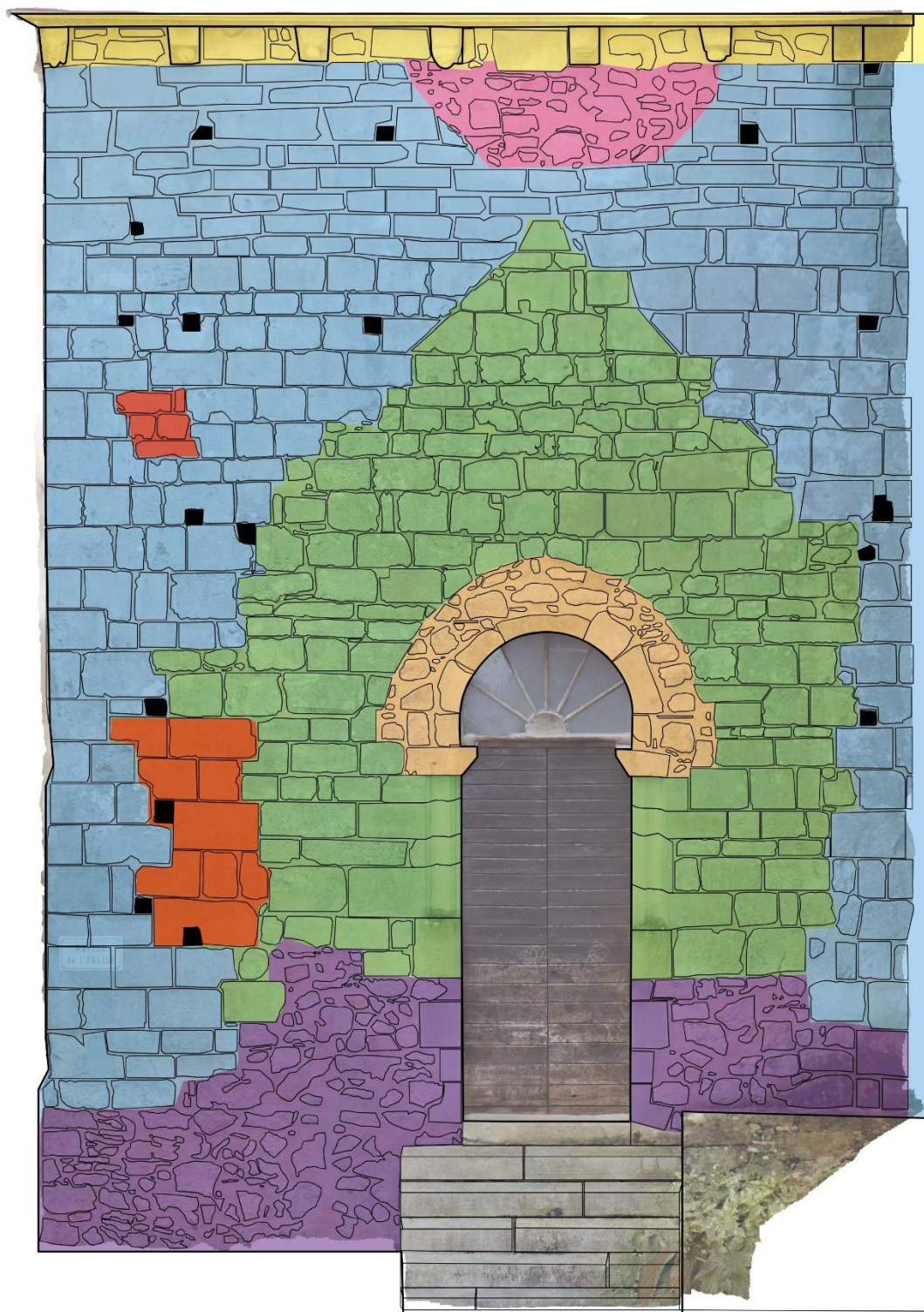
Figure 42 : Différentes unités stratigraphiques de construction (USC) de la façade romane occidentale
