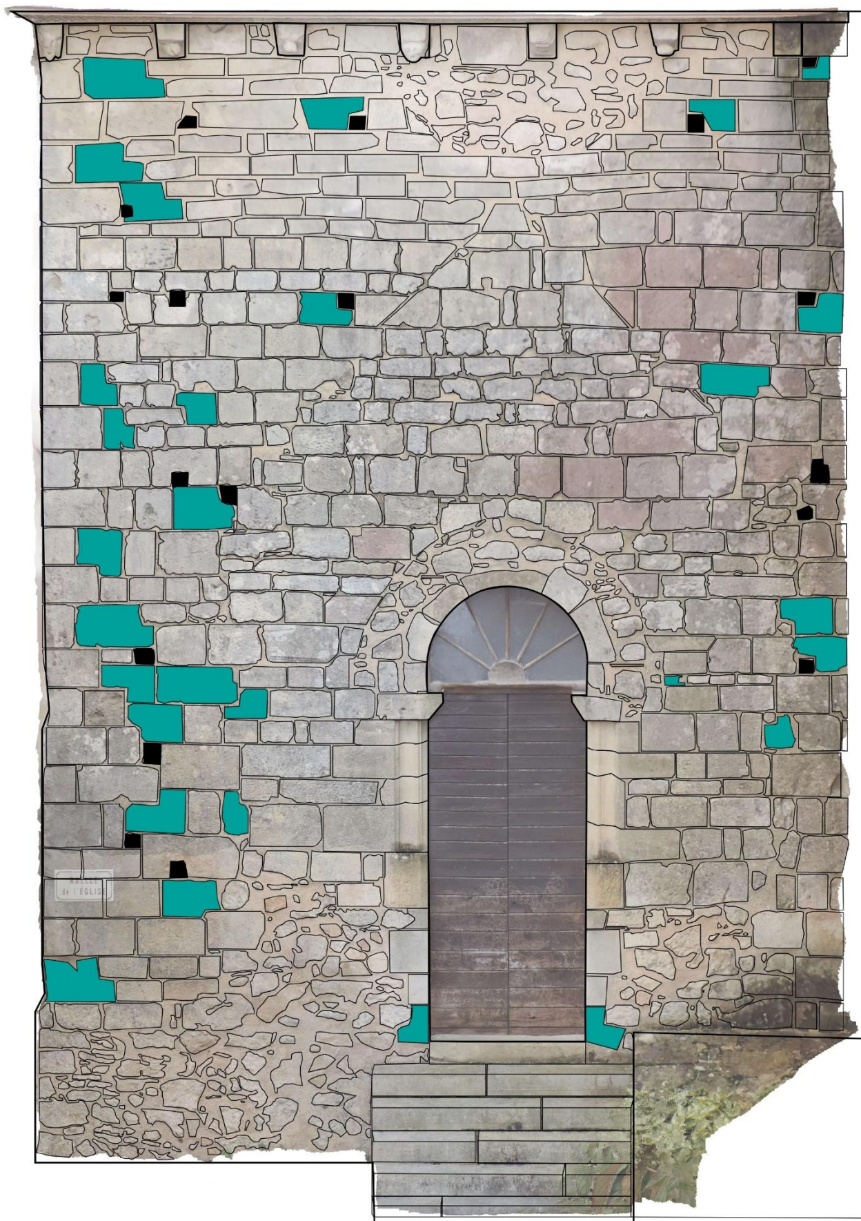
Figure 36 : Recensement des pierres taillées en équerre sur la façade romane occidentale
