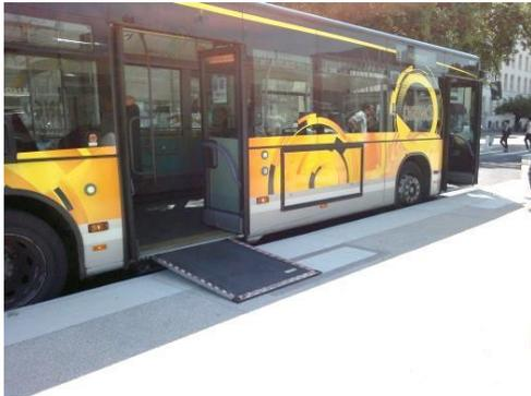
Figure 28 : Palette permettant l'accès au véhicule (Réalisation personnelle)
