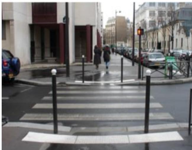
Figure 8 : Traversée avec abaissement du trottoir (Réalisation personnelle)
