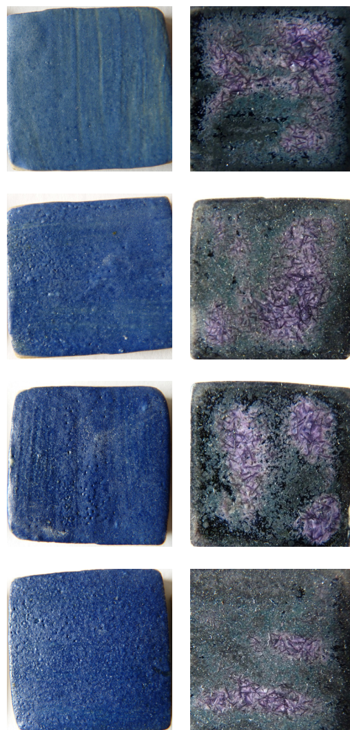
Système de gradation des échantillons. La teneur en oxyde de cobalt augmente au fur et à mesure.
