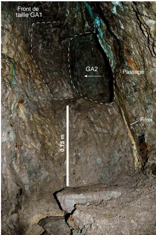
a. Vue du passage entre GA1 et GA2 vers le sud. Les traces d'outil nombreuses sont bien visibles, ainsi qu'un filon contre la paroi ouest.
