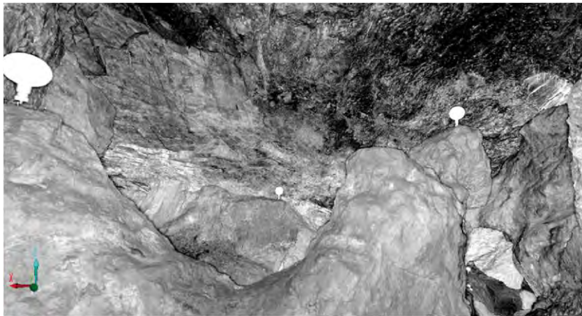
Fig. 18 : Levé depuis la première station à la sortie du scanner, avant traitement.
