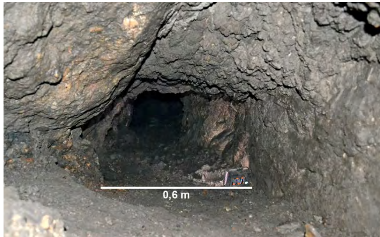
Fig. 77 : Mine de Rougé : galerie d'assistance dans le schiste rejoignant les étages -16 à -22, vue vers l'ouest depuis le point O.
