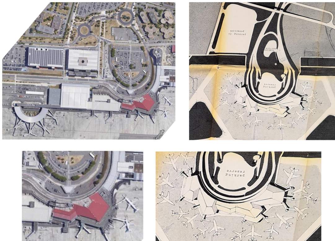
Figure 136 : Comparaison entre le plan masse établi par les Architectes Montier en 1973 et une vue satellite des installations actuelles (2021) de l'aéroport de Toulouse-Blagnac 2
