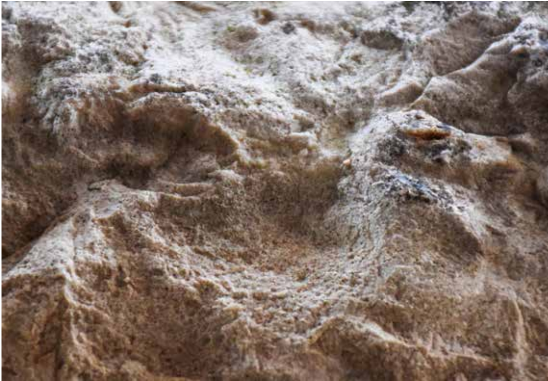
fig. 49 : photographie agrandie d'un bloc de calcaire blanc « de Septfonds » (photographie : Eric CHABANNE)
