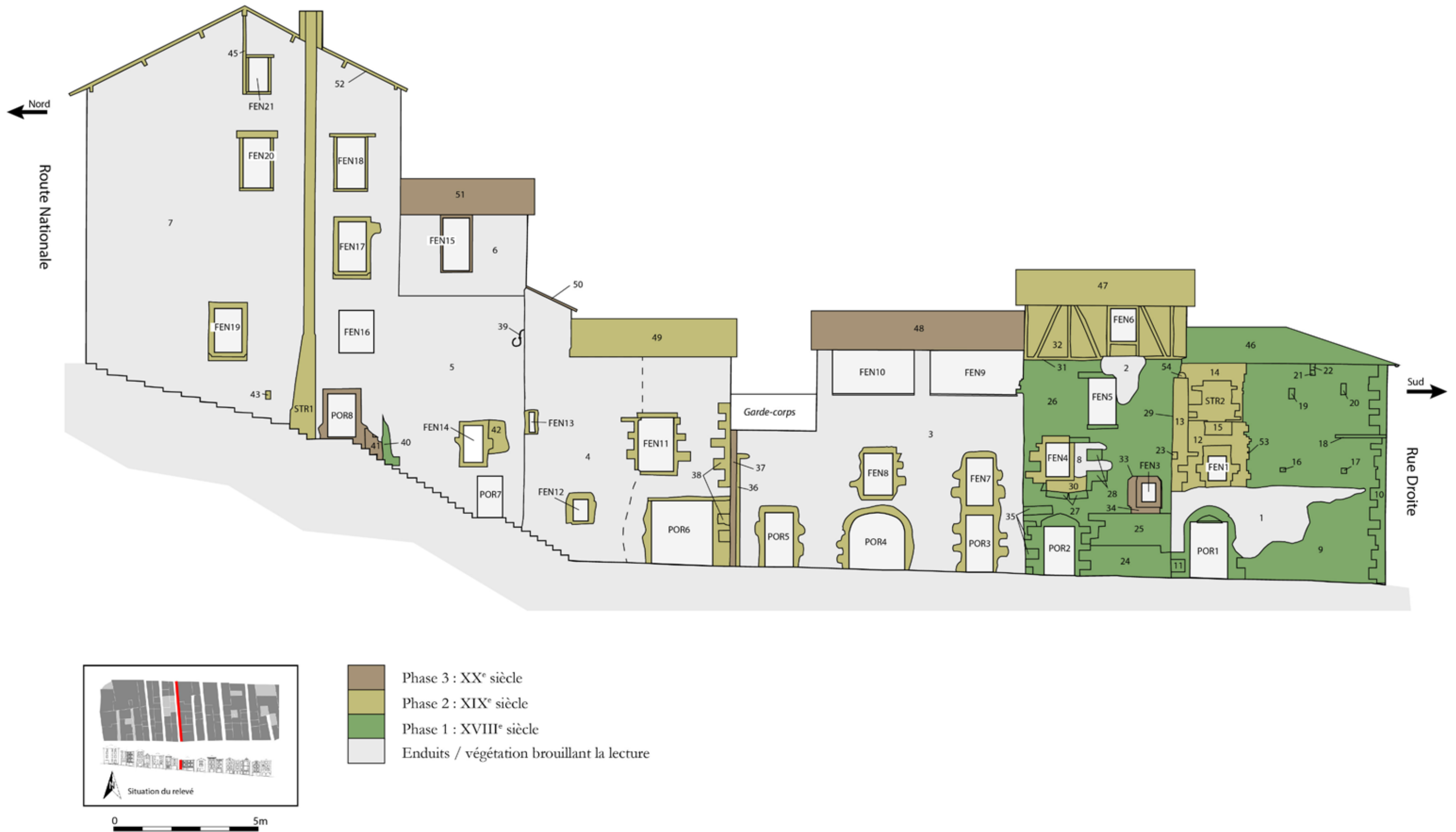
fig. 38 : Relevé phasé de la façade I5_1
