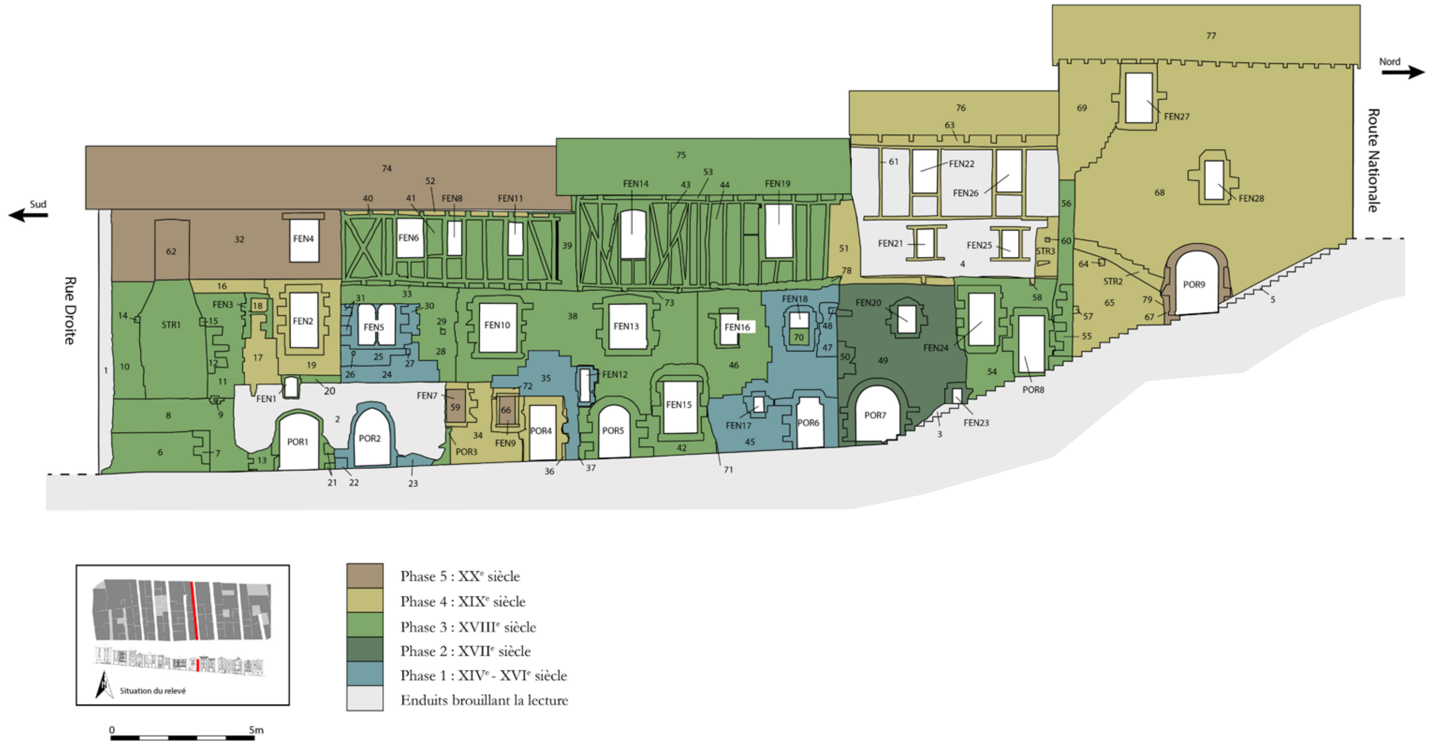
fig. 28 : Relevé phasé de la façade I6_2
