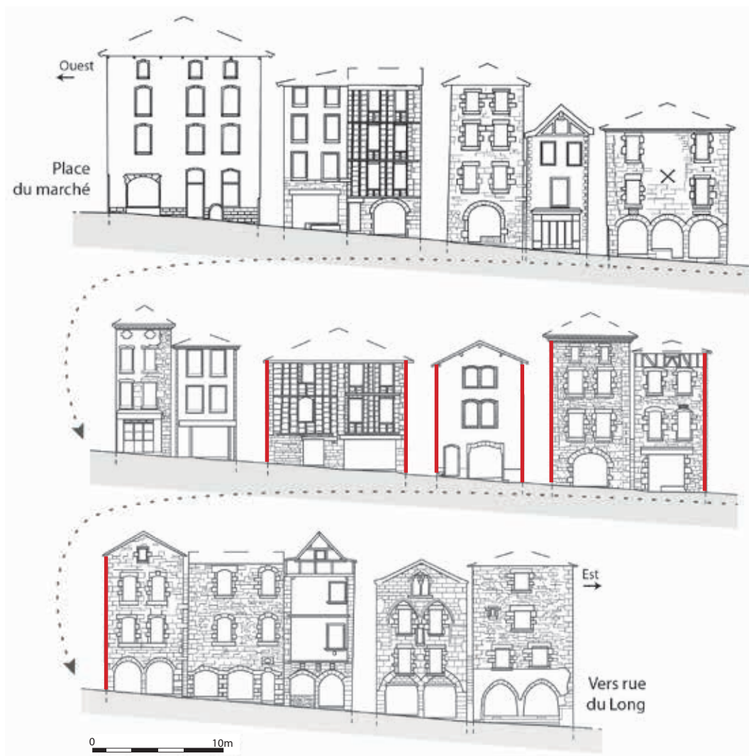
fig. 4 : relevé des façades de la rue Droite (façades transversales relevées en rouge) (Relevé et DAO : Eric CHABANNE)
