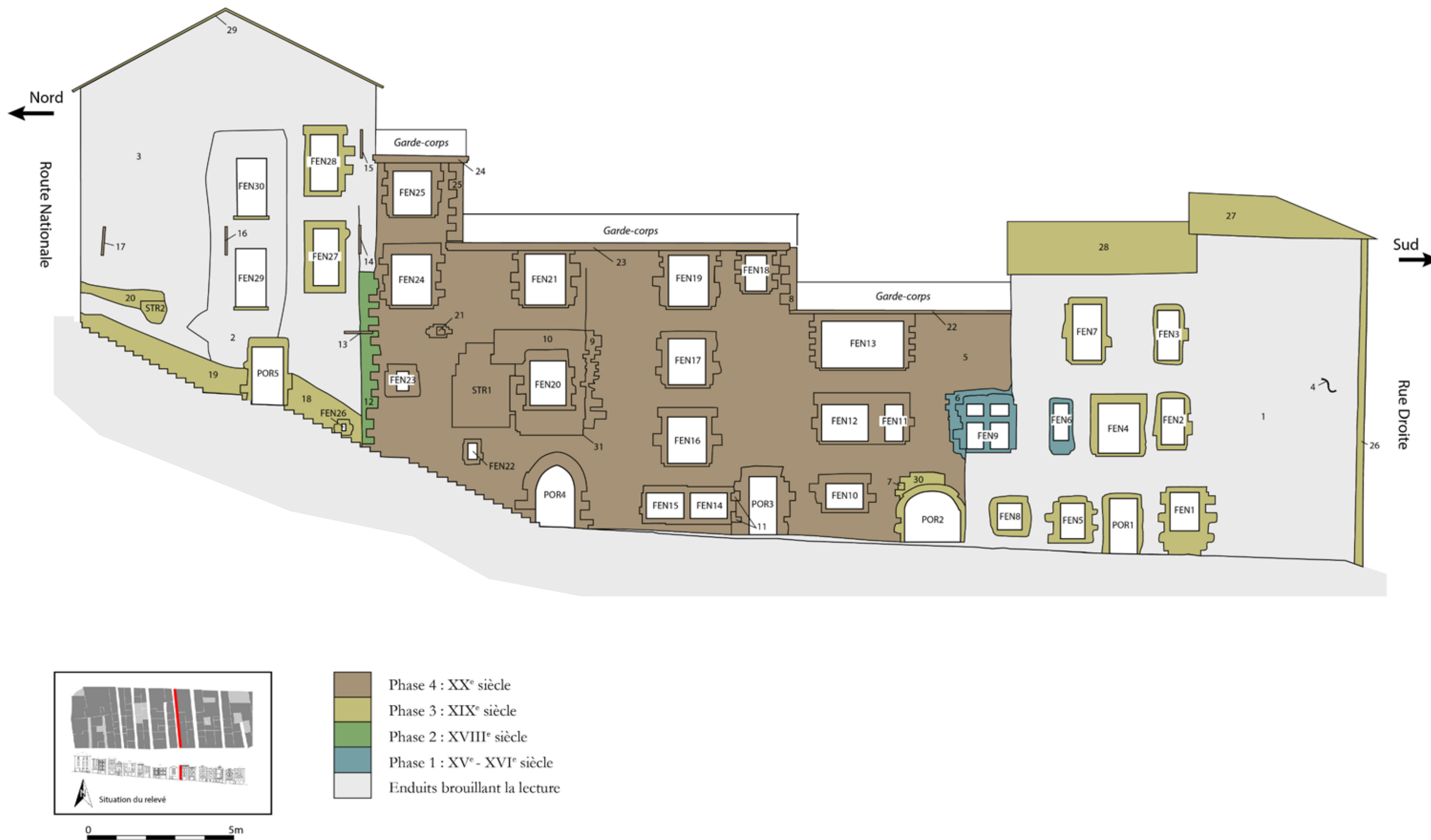
fig. 24 : Relevé phasé de la façade I7_1
