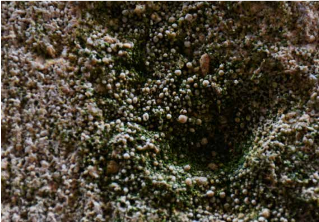
fig. 47 : photographie agrandie d'un bloc de calcaire oolitique du Bajocien (photographie : Eric CHABANNE)
