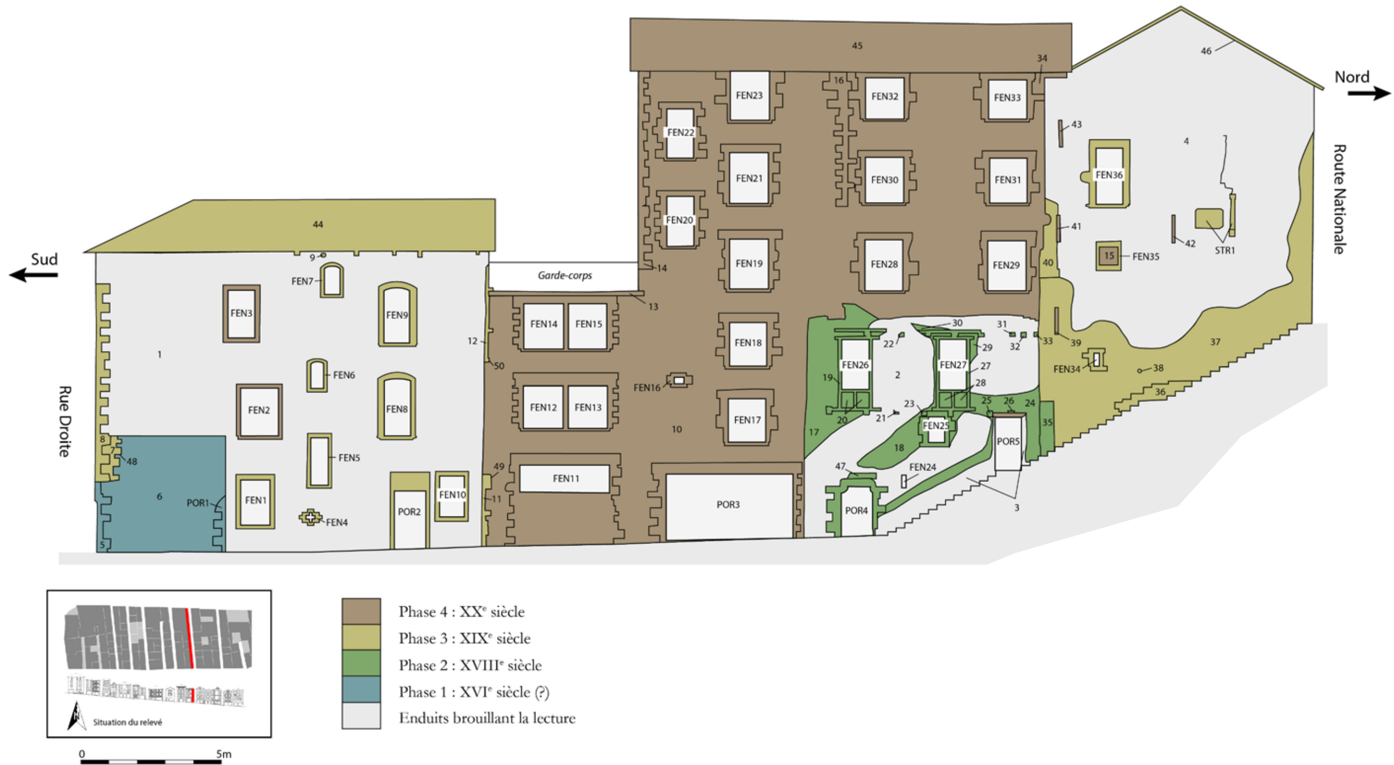
fig. 21 : Relevé phasé de la façade I7_2
