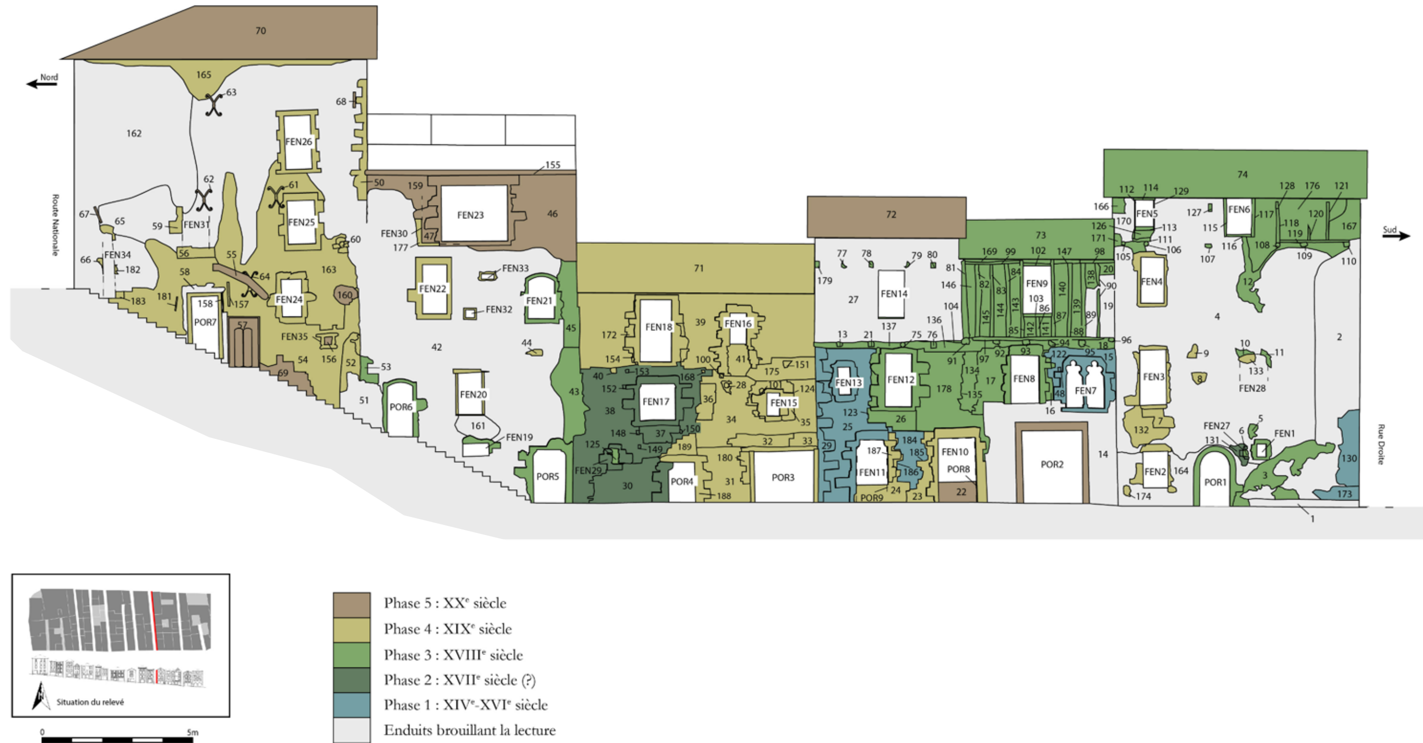
fig. 17 : Relevé phasé de la façade I8_1
