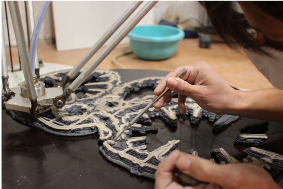
Figure 84 — A. Photographie de l'imprimante 3D en argile (type Delta) conçue par Olivier Van Herpt au 8FabLab de Crest (Drôme) B. Photographie de gestes en cours d'impression d'un fragment de la pièce Archive vivante, Fragments coralliens : Caryophyllia clavus .
