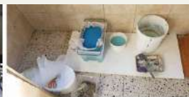
en haut, la sorbonne minimale, avec filtration des eaux polluées, séparation des résidus solides, la spatule, le seau de flocculents.
