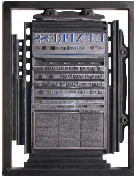
Illu. 17. Anonyme, Forme Typographique en plomb de la Une de l'express du 16 mai 1953 [En ligne] Disponible sur : https://www.passion-metier-imprimerie.fr/pages/flan_imprimerie.php
