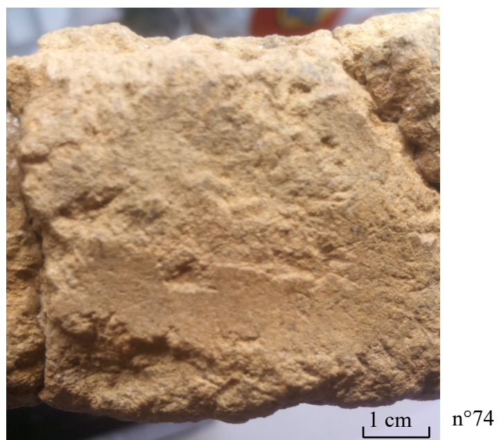
Annexe 27 - Trace de doigt laissée au moment du lissage.
