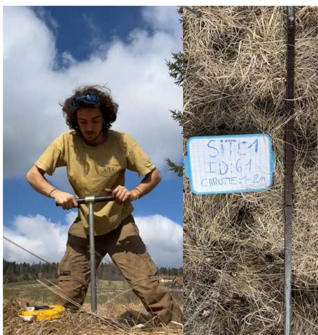
*Figure 22 : Utilisation de la Gouge sur le terrain*
