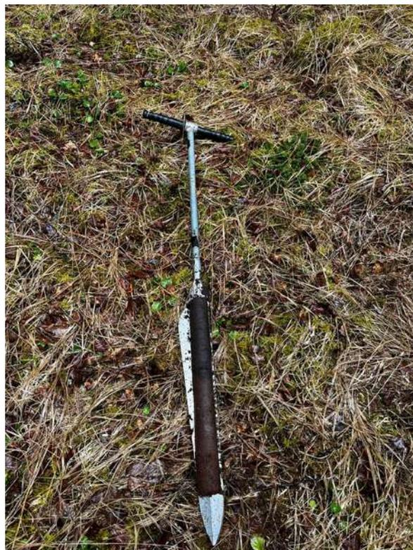
*Figure 26 : Utilisation du carottier russe sur le terrain*
