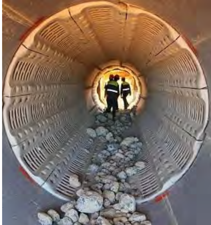
FIGURE 1.14 – Le trommel, engin minier de tri source : [SLN, 2018]
