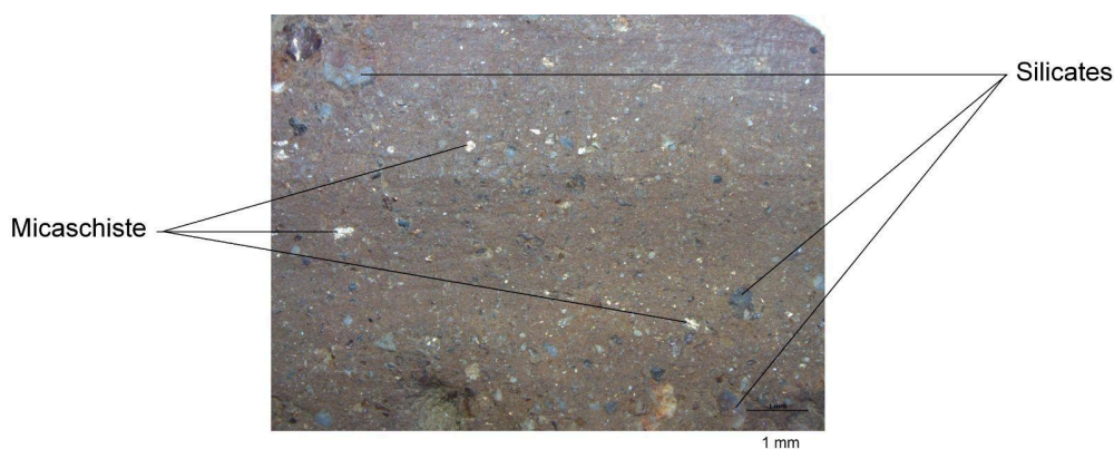
Figure 16 - Les inclusions présentes dans la pâte des céramiques du corpus
