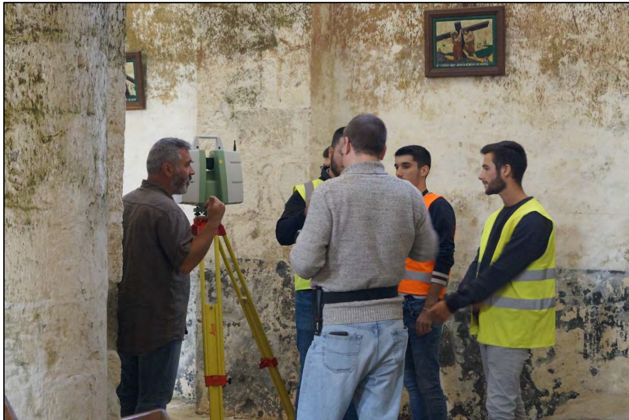
Figure 66 – Scanner 3D de l’EFEC dans l’église de Cellefrouin. Travail des étudiants de 2 ème année de BTS (promotion 2019/2020) sous la direction de Laurent Salomon (Lycée de Sillac) et Olivier Négro (IUT Angoulême).
