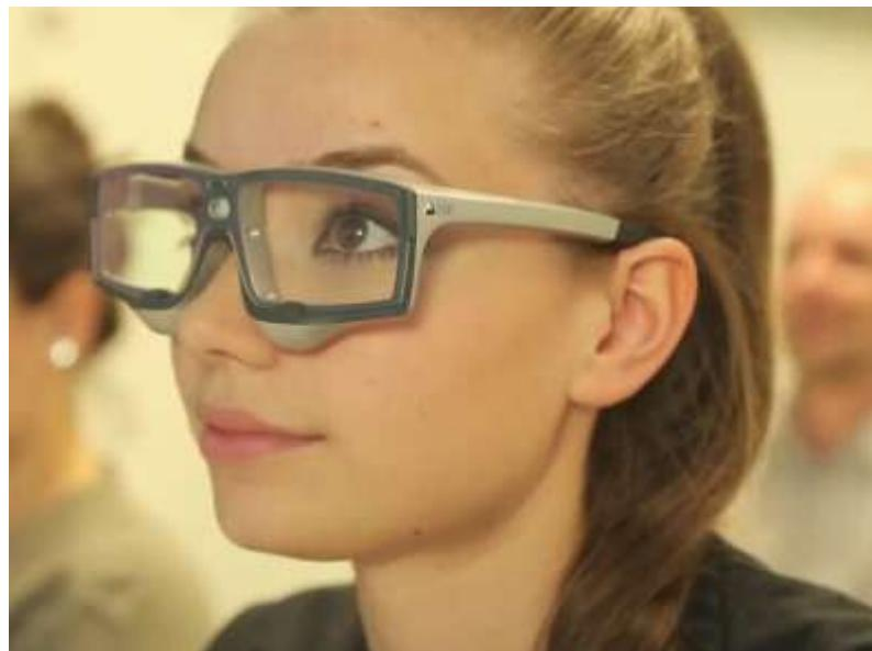
Figure 8. *Dispositif mobile d'oculométrie, sous forme de lunettes (SMI)*
