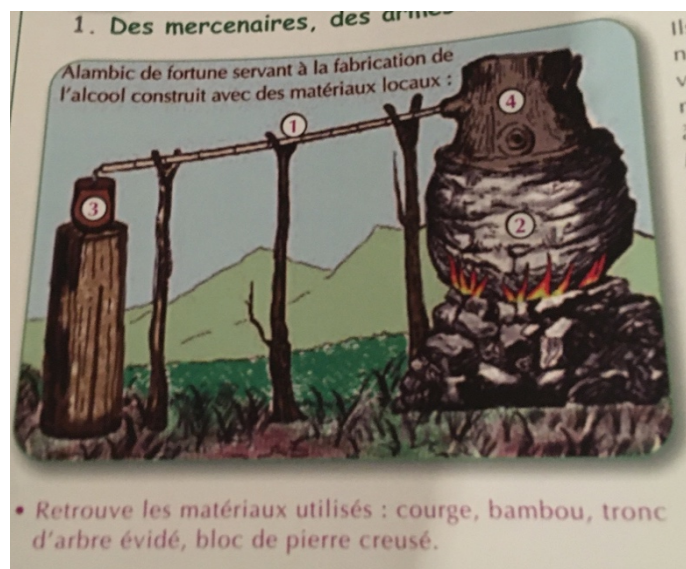
Figure n° 3 : Schéma d'un distillateur d'alcool artisanal Source : Dubois & Lextreyt, 2011 : 28 (photographie du schéma)
