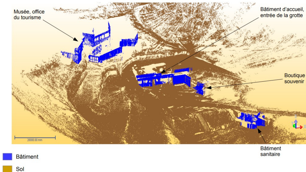
Figure n°32 : Classification de l'extérieur, production personnelle Sur la figure plus haut, j'ai pu effectuer une classification, où il apparaît juste les bâtiments et le sol, j'ai masqué la végétation, pour les bâtiments soient bien visibles.
