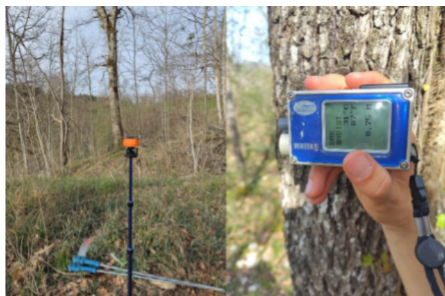
Figure 26: Utilisation de Vertex pour mesurer la distance (photographie prise par Marie Sallebert, 2024)
