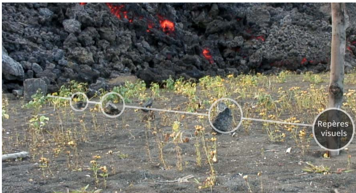
Figure 6.9. Repères « artisanaux » pour estimer la vitesse d'avancée de la lave (Chouraqui, novembre 2014).
