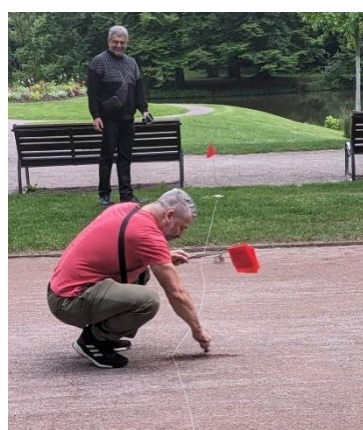
Figure 16 : Marquage au sol des points à relevés
