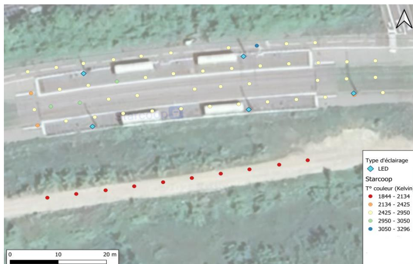
Figure 25 : Valeurs en Kelvin des points luxmètres du parc de la station de tram Starcoop
