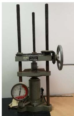
Figure 46: Compactage à l'aide d'une presse
