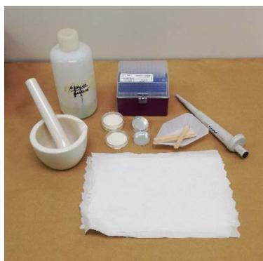
Figure 45: Matériel nécessaire à la fabrication des pastilles
