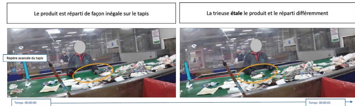
Figure 40. Chronophotographie d'une trieuse qui étale la matière (la flèche en bleu montre un produit qui sert de repère pour l'avancée du tapis ; en orange la zone devant la trieuse où elle étale le produit)
