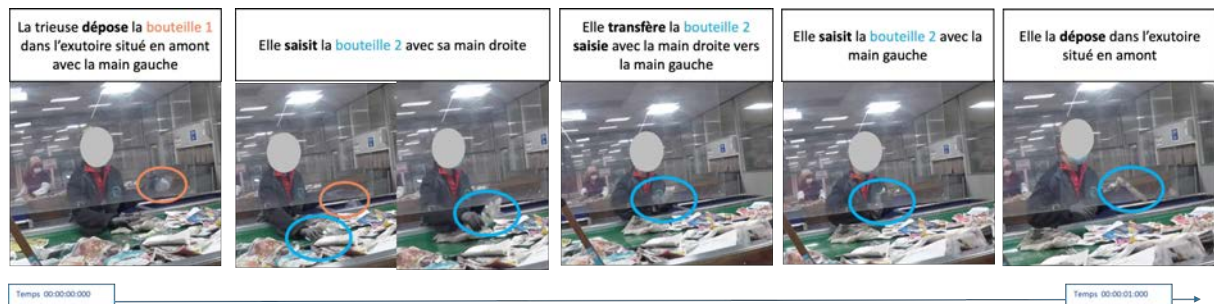
Figure 42. Chronophotographie du transfert d'un produit saisi en aval vers la main situé en amont du flux
