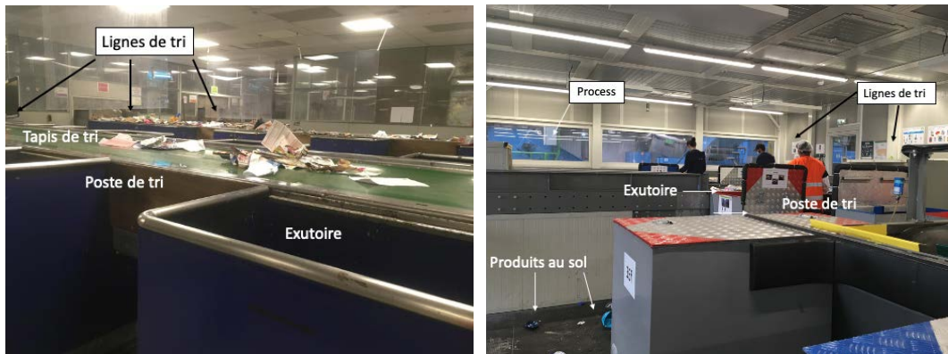
Figure 33. Photographie de l'intérieur de la cabine de tri (à gauche le CDT A durant une pause, et à droite le CDT C)
