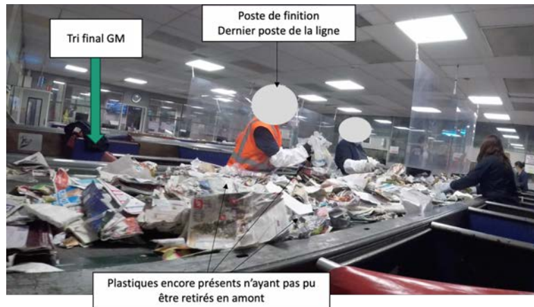
Figure 44. Photographie d'une ligne JRM basculée en GM 107 en raison d'une quantité de produit trop importante pour assurer une qualité optimale 108
