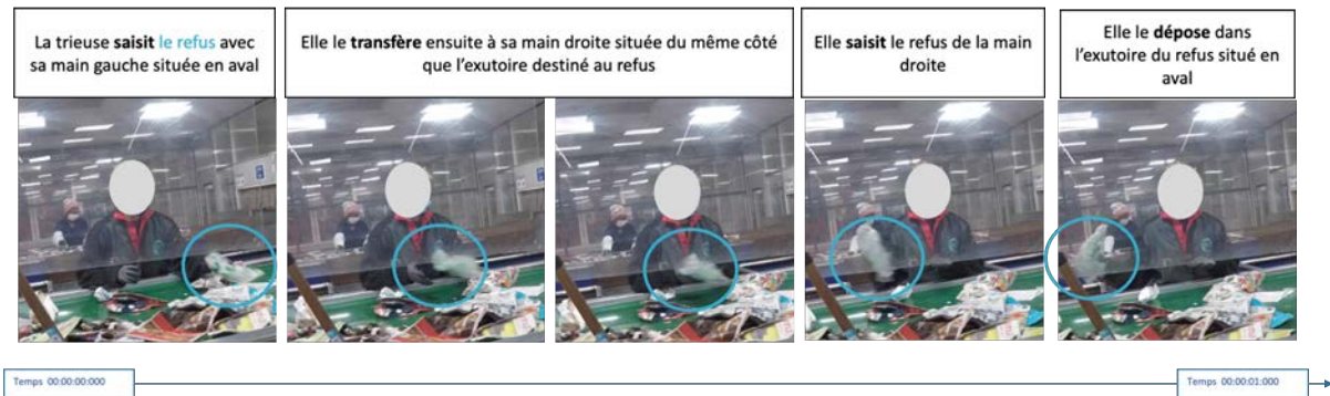
Figure 41. Chronophotographie du transfert d'un produit saisi en amont vers la main situé en aval du flux
