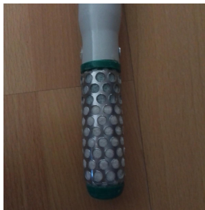
Figure 25 : Zone poreuse de la sonde tensiométrique. Source : Léo BAILLY
