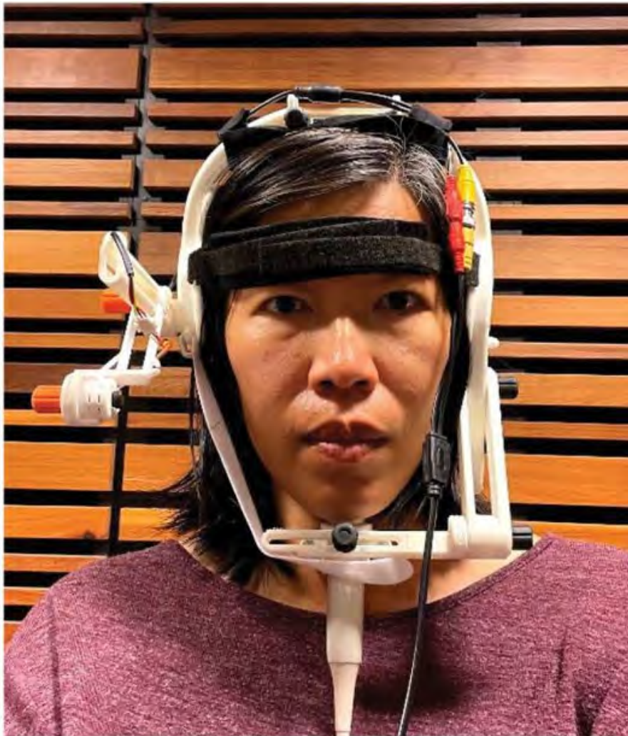
FIGURE A.3 – Système de maintien de la sonde échographique proposé par Ma et Wrench 2022. In (J. K.-Y. MA & WRENCH, 2022)
