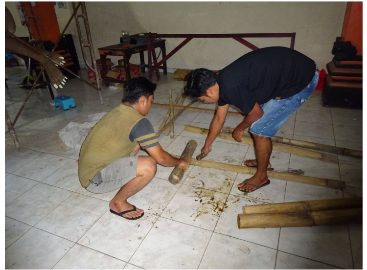
Illustration 36: Découpe de baguettes en bambou - 07/03/23
