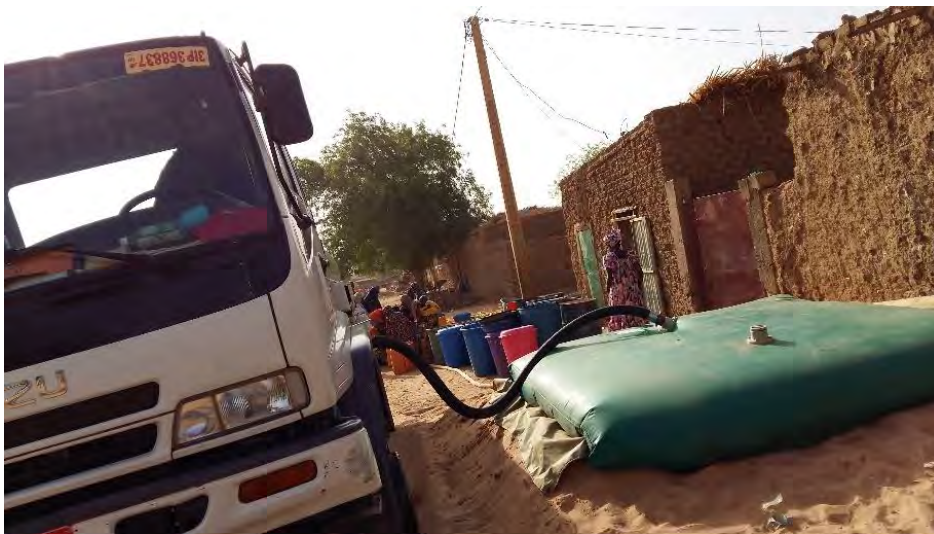
Photo 87 : le camion-citerne en train de remplir une des deux bâches du quartier Carré
