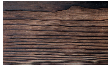
brossé, brûlé et brossé
