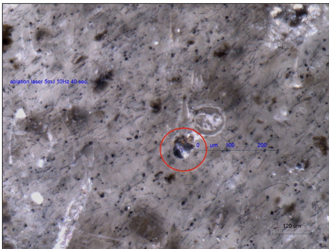
Figure 23. Pièce n°779 observée à la loupe binoculaire. Le zircon ayant impacté le prélèvement est entouré en rouge. Grossissement x120.
