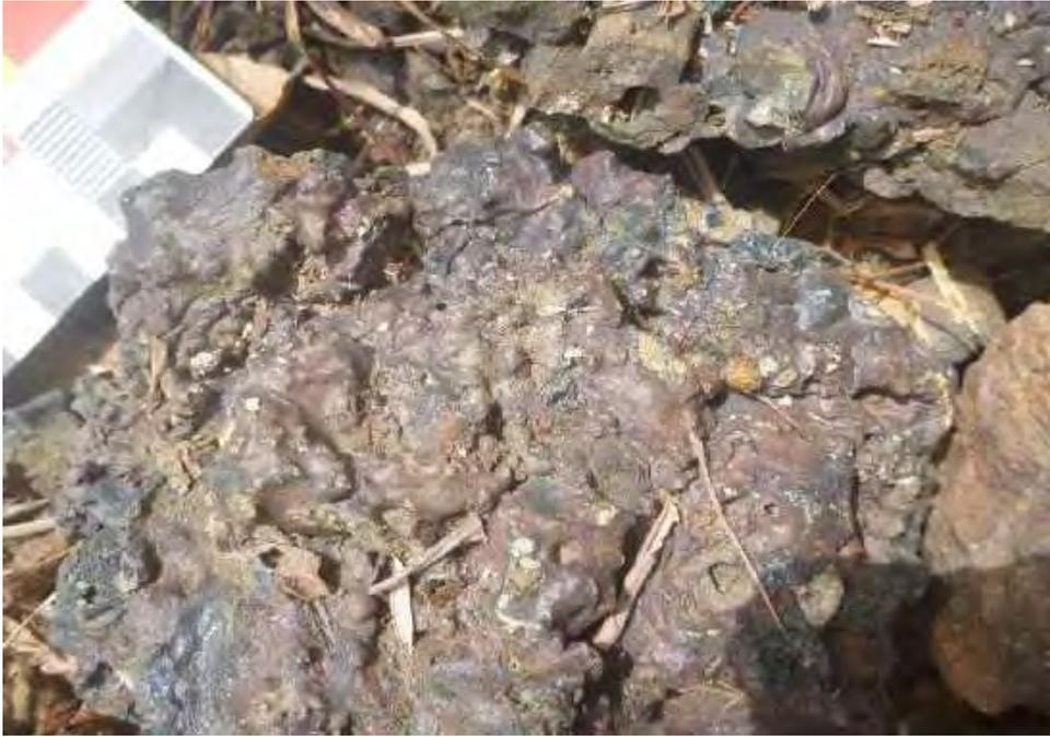
*Figure 124 : Des scories de fond de four grises dense sur le site de Tèpouhotè 2 (© T. Kouagou 2020)*
