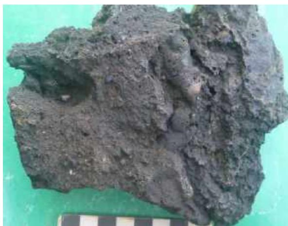
*Figure 181 : Scorie de fond de four argilo-sableuse (©T. Kouagou 2021)*
