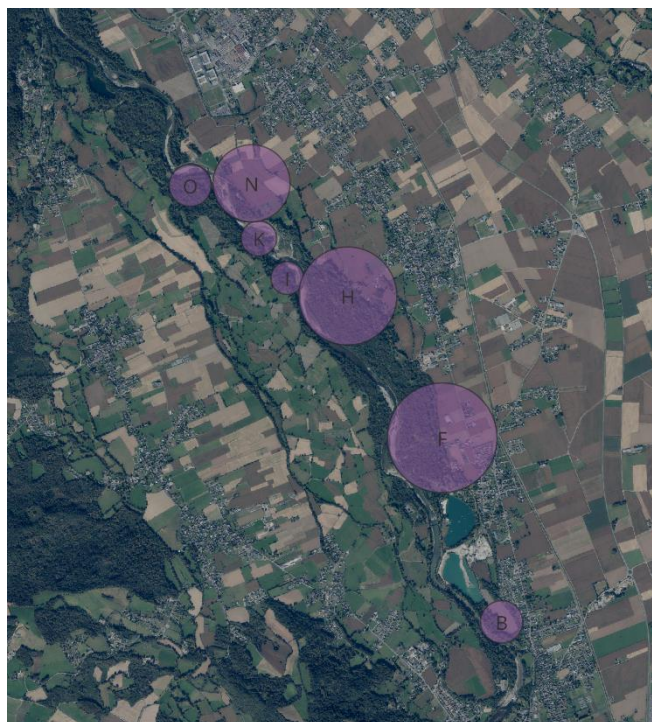
Figure 27 : Cercles pour le calcul de la sinuosité des méandres. Source : IGN, 2021.
