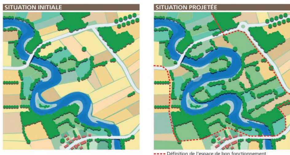
Figure 17 : Exemple d'un scénario d'évolution possible sur un cours d'eau à méandre. Source : OFB (2018).
