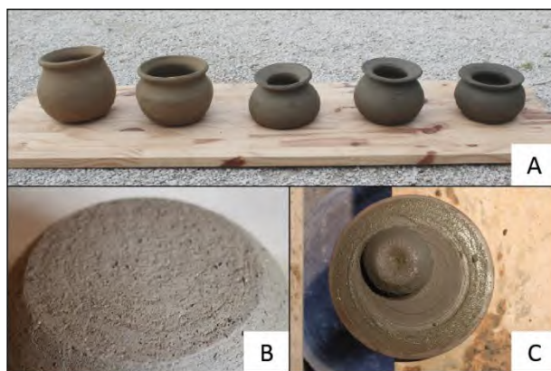
Figure 15 : Résultats de la série n° 1 par tournage : A) Pots obtenus (avec de gauche à droite 10 %, 20 %, 30 %, 40 % et 50 % de dégraissant), B) Traces créées par le tournassage et C) Décentrage systématique de la masse d'argile à partir de 50 % de dégraissant.
