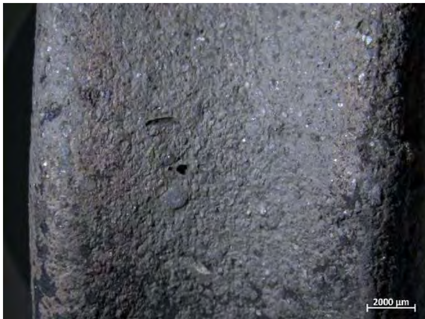
Figure 17 : Anse à surface à grains saillants partiellement recouverts et stries filetées (Castel-Minier : marmite 3074-3126)
