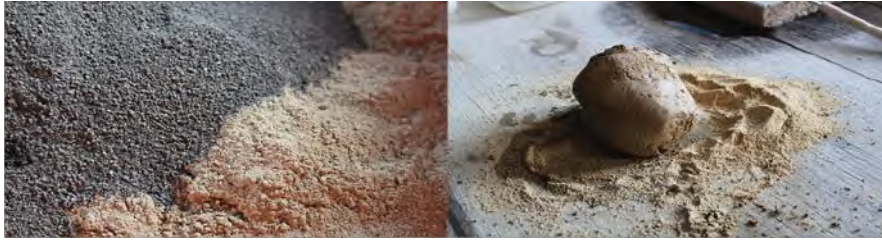
Figure 6 : Mélange des matières premières pour la préparation des différentes pâtes céramiques
