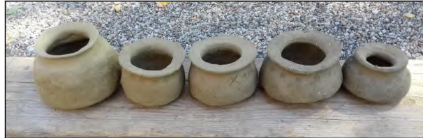
Figure 16 : Résultat de la série n° 2 montée à la main (avec de gauche à droite 10 %, 20 %, 30 %, 40 % et 50 % de dégraissant)
