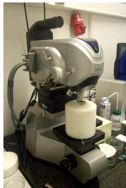
Figure 20. Microscope confocal à balayage laser Keyence VK-100, Eberhard Karls Universität, Allemagne
