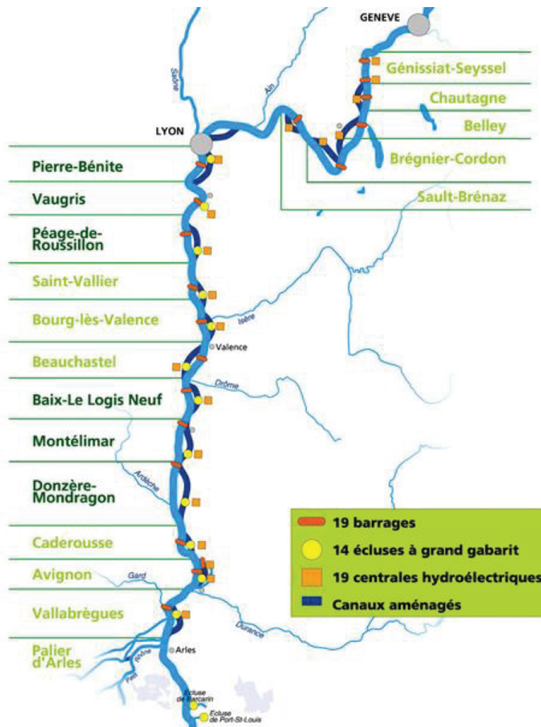
Figure 1 Localisation des grandes infrastructures mises en place sur le Rhône. Source: cnr.fr
