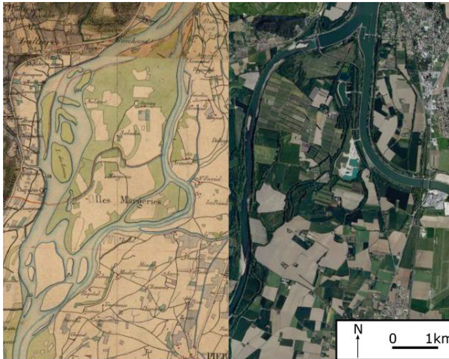
Figure 19 L'ancien Rhône avec ses nombreuses îles et son rétrécissement après la mise en place du canal Donzère-Mondragon. Source: IGN, carte d'état-major (1820-1866) et photographie aérienne (2007) retouchées sous Inkscape
