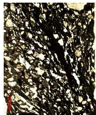
Figure 123: Jointure entre deux éléments assemblés marquée par une couche de matrice argileuse non dégraissée (échantillon 3.03)
