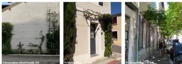
Dans le cas d'une végétalisation de façade, le dispositif doit être discret - câble métallique. Dans le cas d'un auvent il doit lui-même être métallique et simple.
