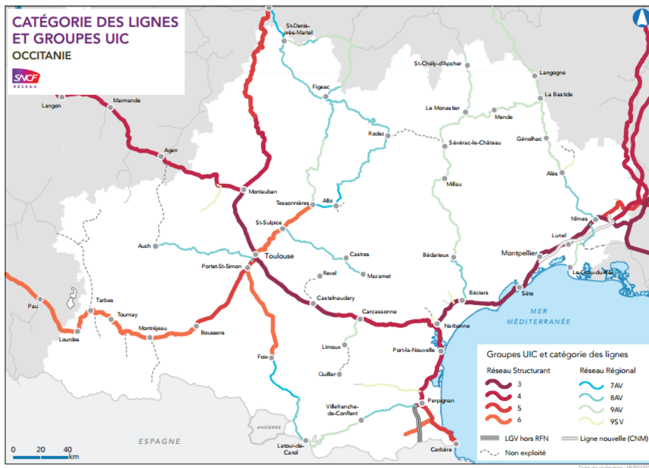
Figure 15 : Classement UIC des lignes ferroviaires de la région Occitanie (document SNCF Réseau)
