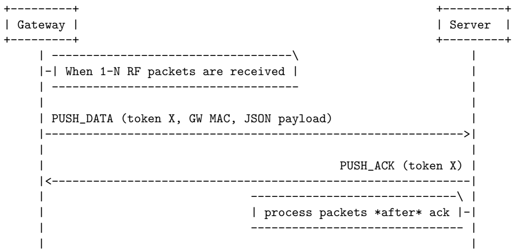
FIGURE 2.12 – Diagramme de séquence d’un relayage de trame
