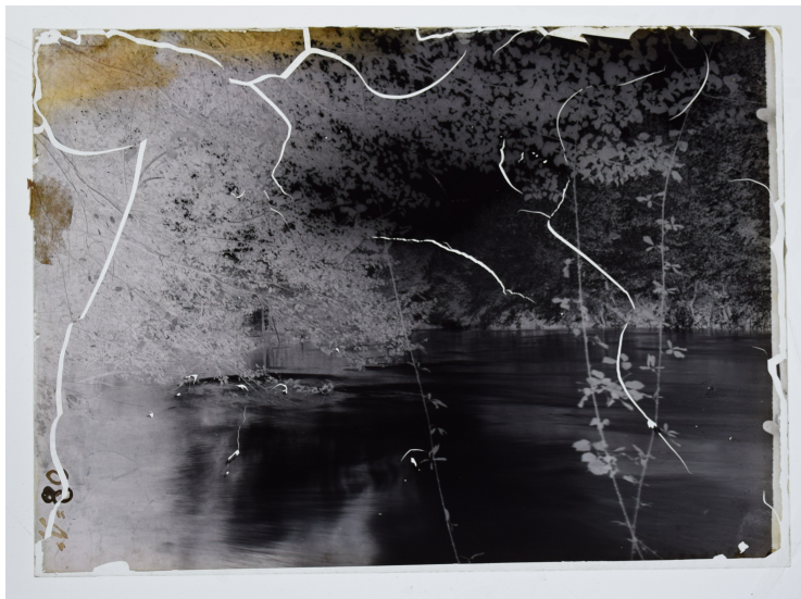
Figure 5 : Décollement de l'émulsion d'une plaque de verre.
