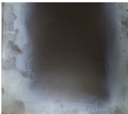
Présence d'un miroir d'argent sur un négatif souple.
