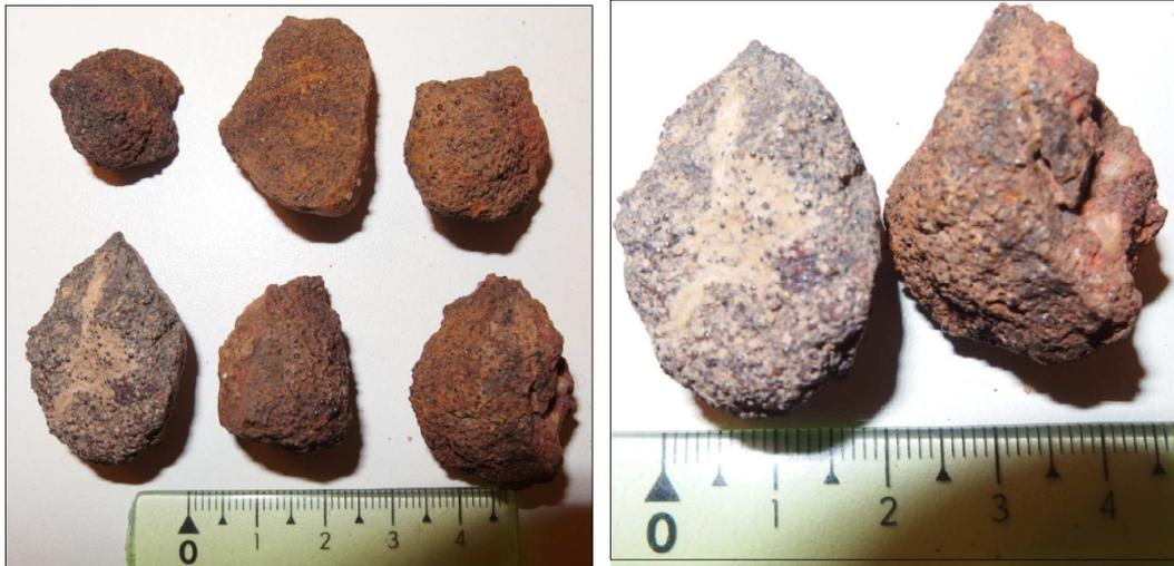
Figure 37 : Echantillons de minerai de Lolo. Le minerai est formé d'un agglomérat d'éléments arrondis visibles à l'œil nu.
