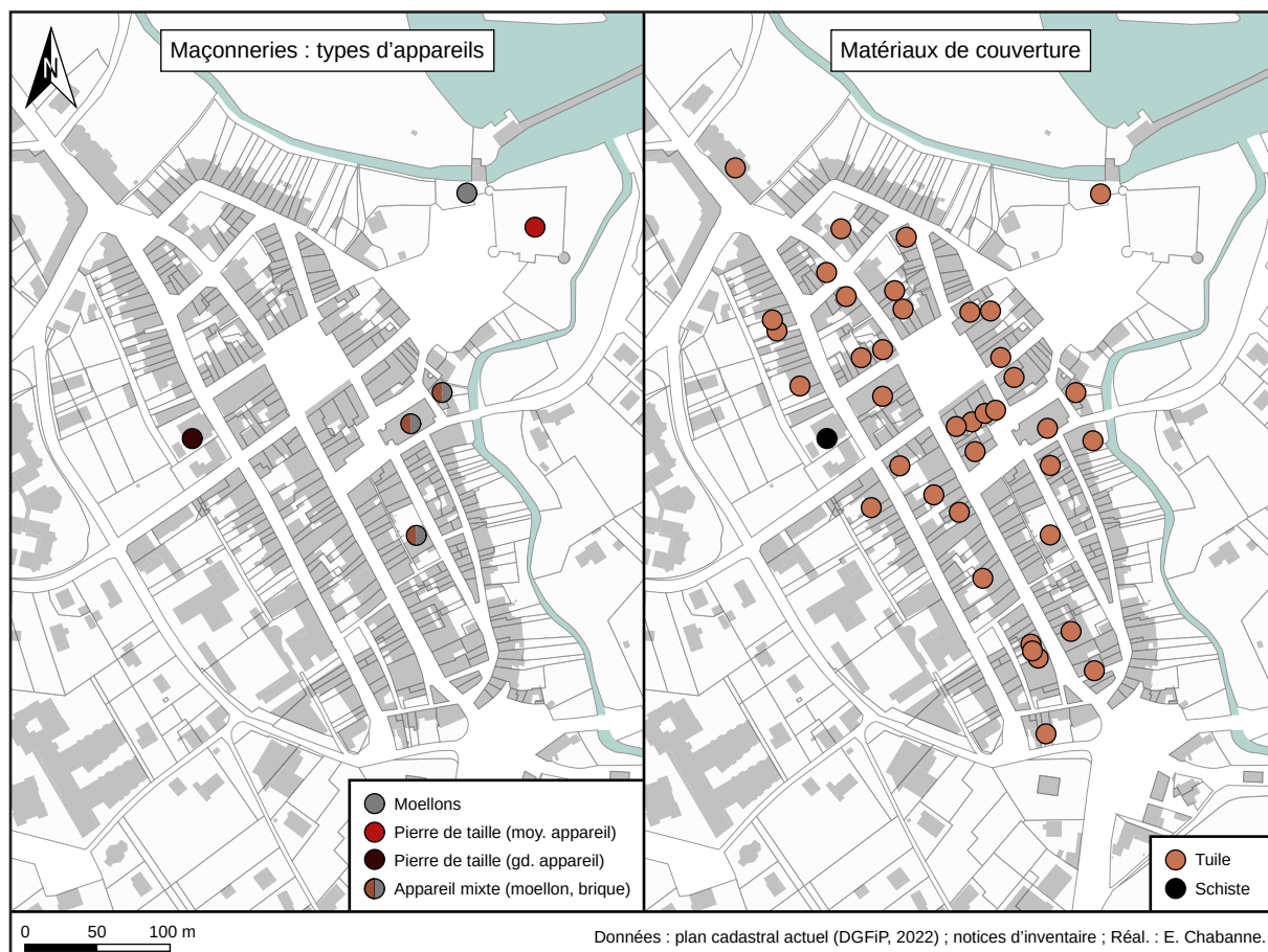
Fig. V-18 : Le bâti de Nègrepelisse, mise en œuvre, matériaux de hourdis et de couverture.
