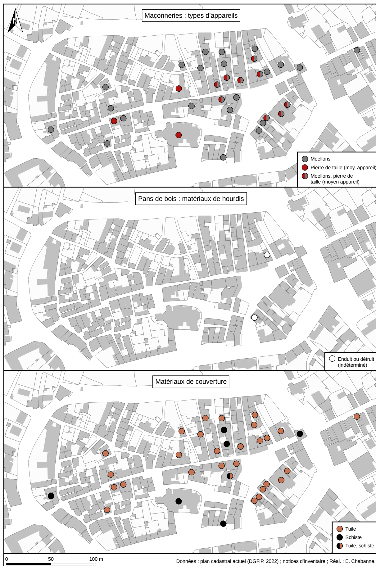
Fig. II-27 : Le bâti de Najac, mise en œuvre, matériaux de hourdis et de couverture.
