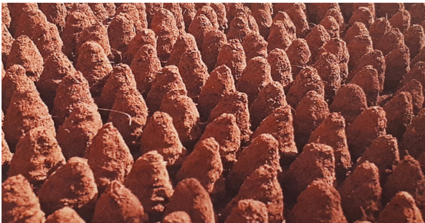
Ci-dessous : Briques crues modélées de forme lenticulaires, Niger, à la fin des années 80. Photo : CRATerre - Thierry Joffroy
